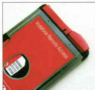
Antenna. A kártyatelefon antennája rugós mechanizmussal emelkedik ki a kártyából
