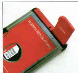
Antenna. A kártyatelefon antennája rugós mechanizmussal emelkedik ki a kártyából
