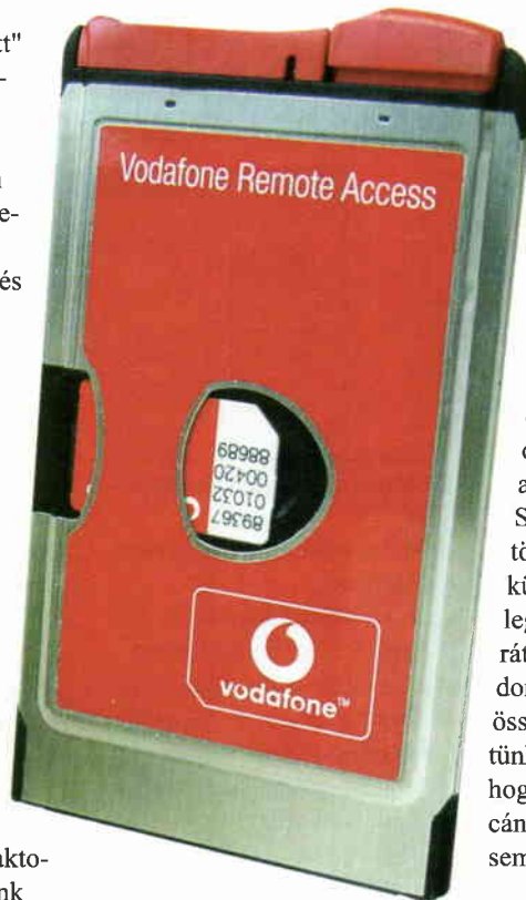
Kártyatelefon. A Vodafone Mobile Connect Card a notebook PCMCIA aljzatához csatlakozik.
