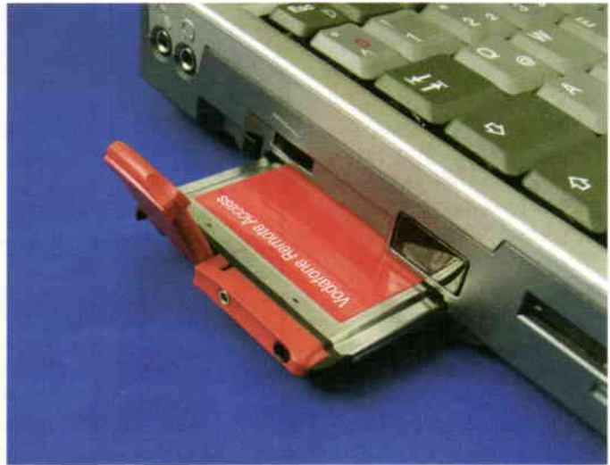
Kártyatelefon. A Vodafone Mobile Connect Card a notebook PCMCIA aljzatához csatlakozik.
