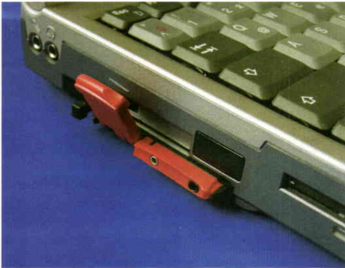
Kártyatelefon. A Vodafone Mobile Connect Card a notebook PCMCIA aljzatához csatlakozik.
